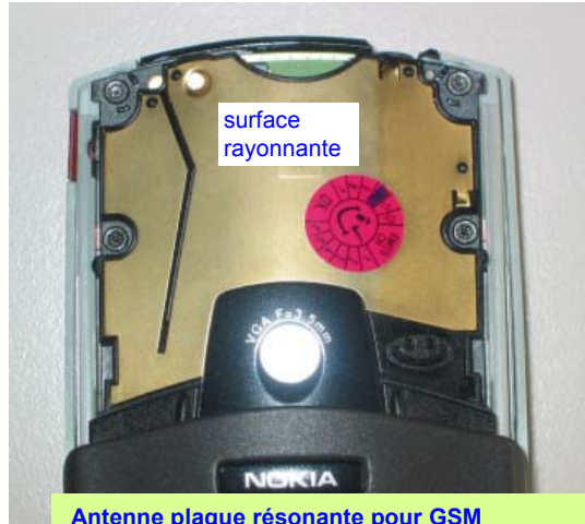
Antenne plaque résonante pour GSM ▪ faible encombrement, bi-bande, gain faible ▪ nécessite un logiciel de conception
