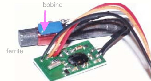
Récepteur de signaux horaires DCF à 77 kHz
