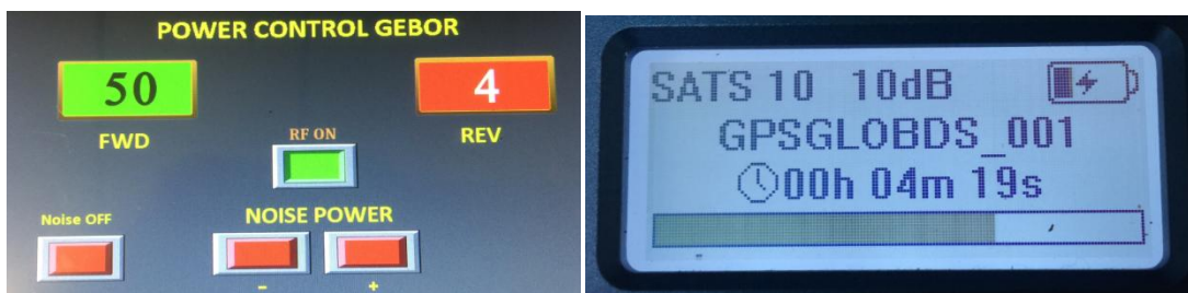
Affichage pour Jammer 'Off' et Spoofer 'On' en émission de 3 constellations mais Régulé à -10 dB
