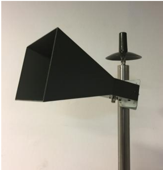
Cornet (non contractuel) 15 dB polarisation verticale en substitution à l'antenne Omnidirectionnelle 700/2700 MHz
