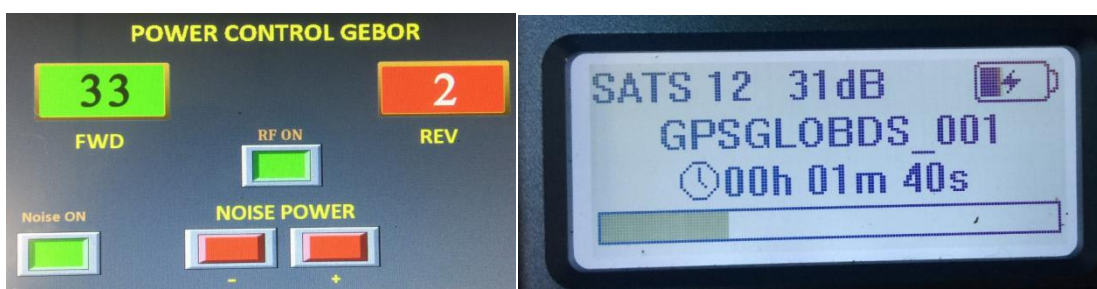
Affichage pour Jammer 'On' et Spoofer à -31 dB. Brouilleur réglé pour une mi-puissance de 40 Watts.
