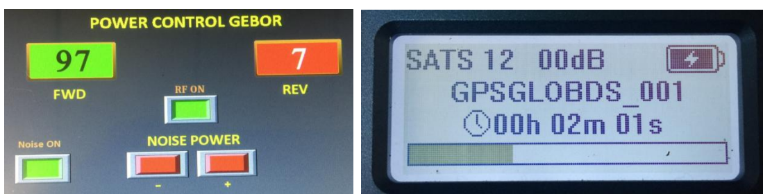
Affichage pour Jammer 'On' et Spoofer à -31 dB. Brouilleur réglé pour une mi-puissance de 40 Watts.
