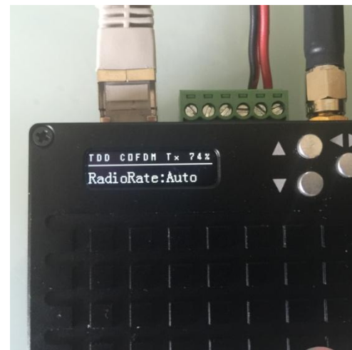
Choisir le niveau de puissance à utiliser (27 dBm recommandé) et le débit Radio
