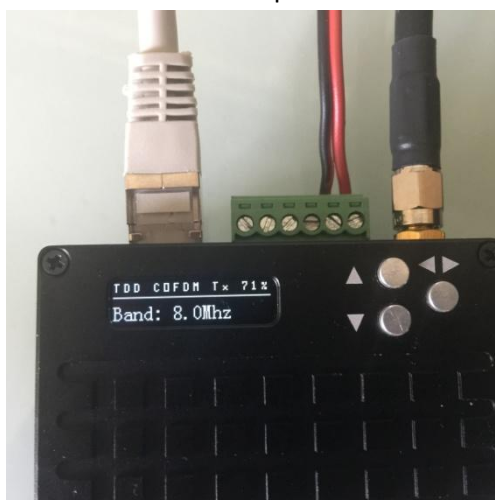
Choisir le niveau de puissance à utiliser (27 dBm recommandé) et le débit Radio
