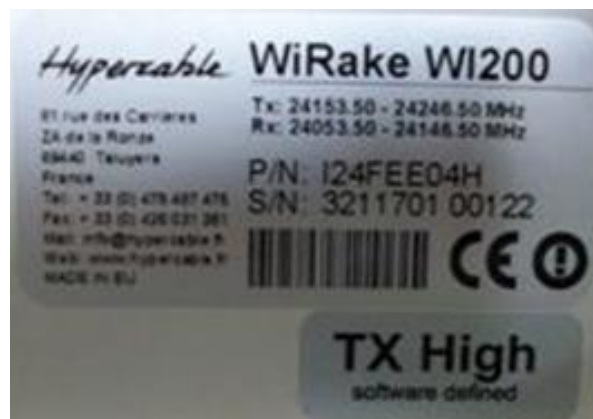
Figure 2. Marquage indiquant la fréquence et la polarisation
